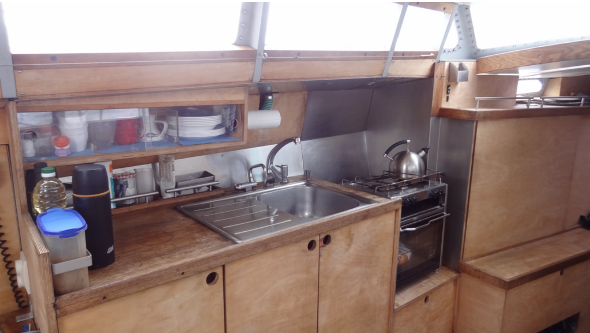
Pantry. Links unten Kühlschrank; Mitte unter der Spüle sind Bestecke und Plastikbehälter, rechts unter der Spüle ist Mülleimer und Putzzeug, daneben Gasherd mit Backofen halbkardanisch aufgehängt. Unter dem Ofen Töpfe und Pfannen
