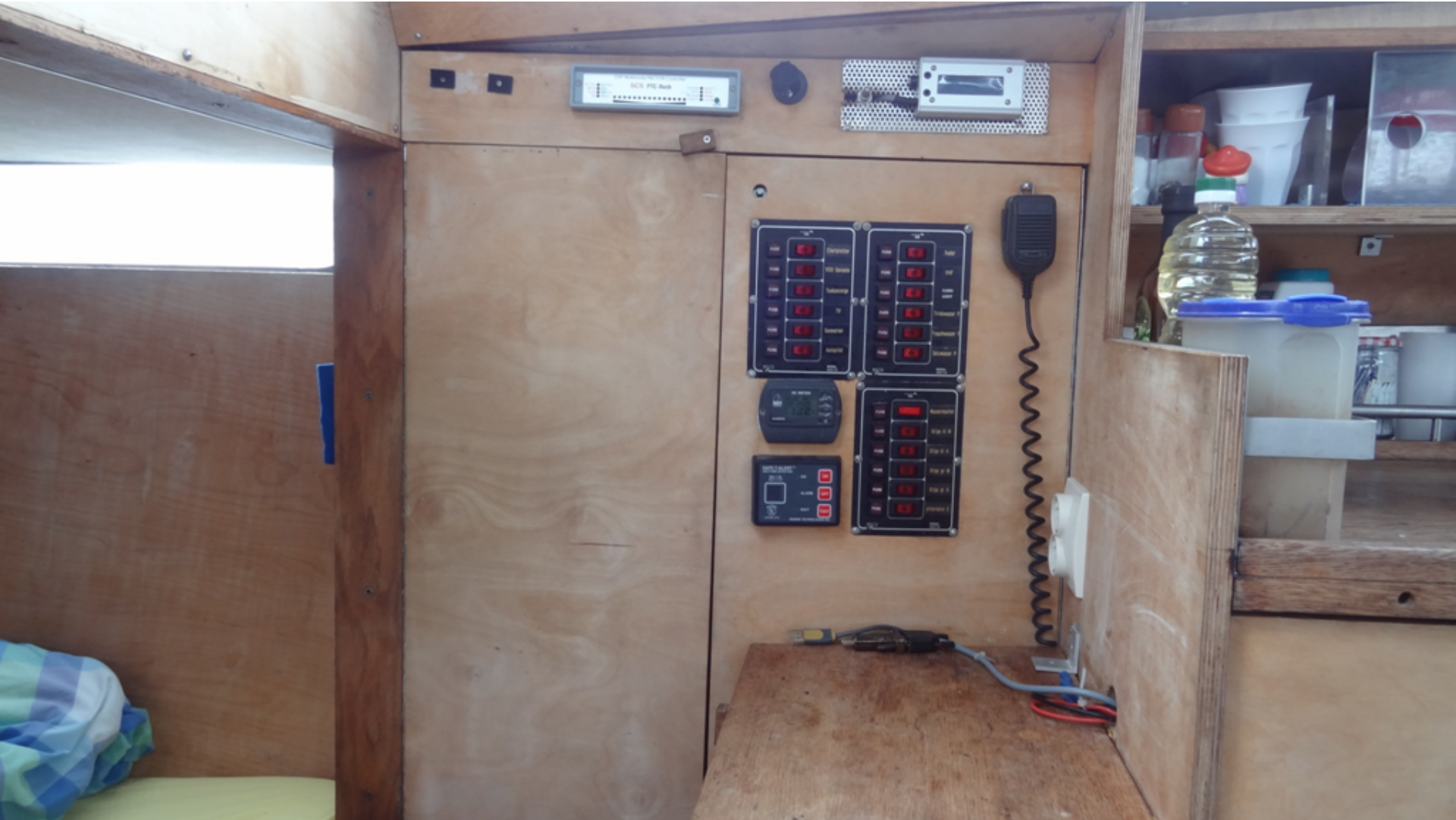
Naviecke mit Schaltern, Batteriewächter, Paktor Modem, Regler für Schleppgenerator
