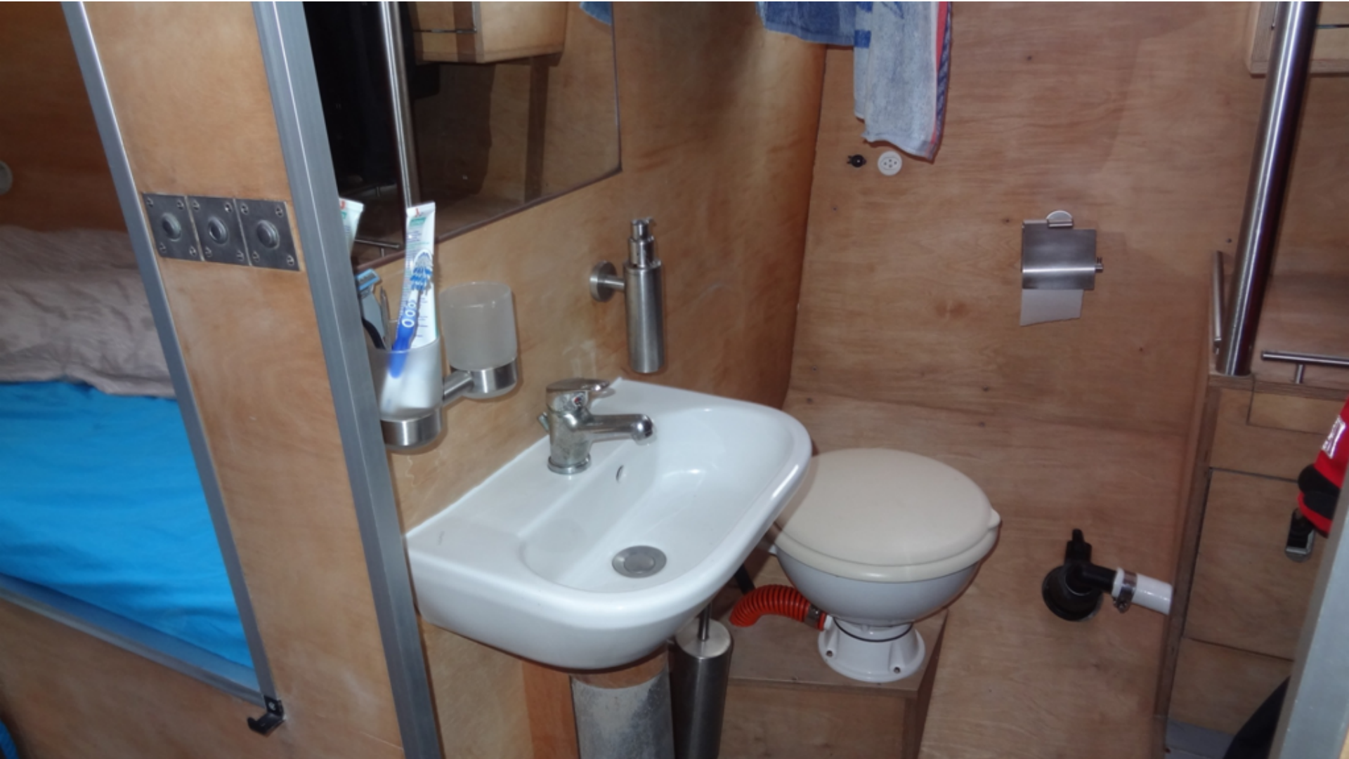
Das Badezimmer mit Vakuumpklo und Waschbecken
